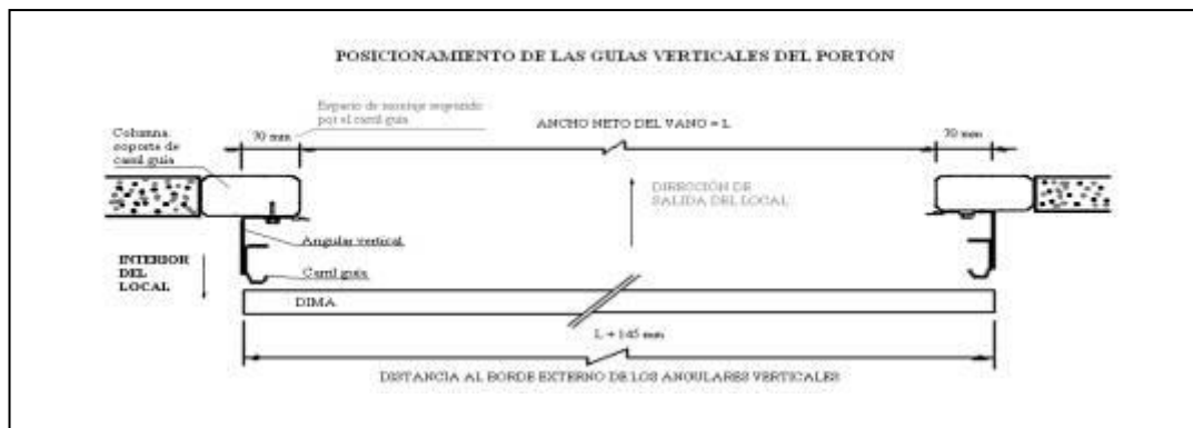
Fig. IA Colocación de Guías Verticales (Portón Tipo Industrial)
